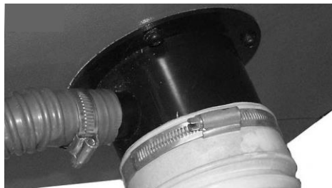
Joonis 14. Paigaldage imemisvoolikud
