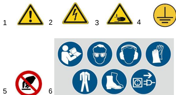
Joonis 1. 1 Ohuhoiatus 2 Ohtliku elektripinge hoiatus 3 Ülajäsemete muljumisohu hoiatus 4 Maandussümbol 5 Puudutamise keeld 6 Ohutusjuhised
